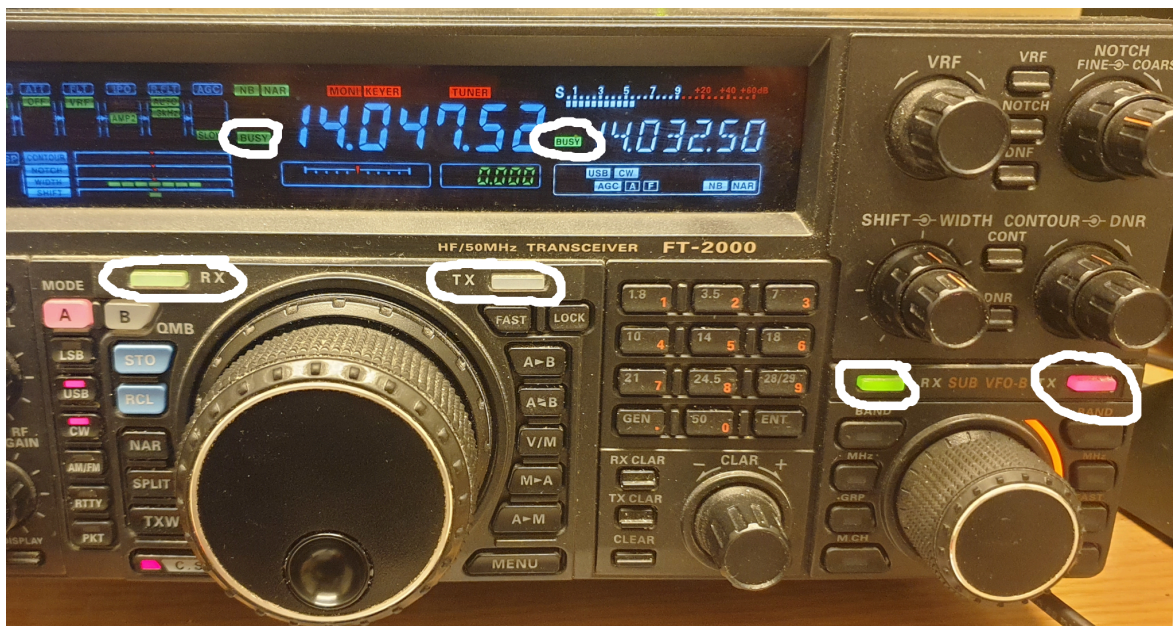
Bild 10: Riggen lyssnar nu på både huvud-VFO:n och sub-VFO:n, båda är BUSY, sub-VFO:ns RX-knapp lyser grönt. Riggen är också redo att sända på sub-VFO:ns frekvens, dess TX-knapp lyser rött (TX-knappen för huvud-VFO:n är släckt).
