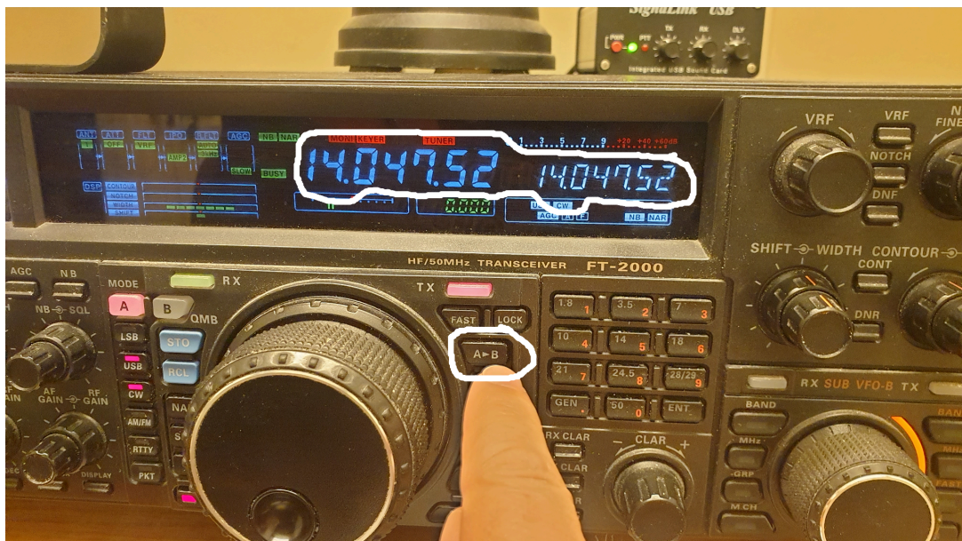
Bild 8: Genom att trycka på A > B-knappen så får man över sub-VFO:n på samma band och mode som huvud-VFO:n.
