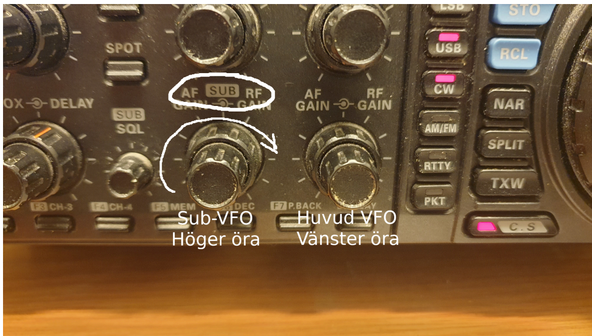
Bild 11: Huvud-VFO:ns volymknappar närmast den stora huvud-VFO-ratten. Det ljudet hamnar i vänster öra när man aktiverar sub-VFO:n. Sub-VFO:n volymknappar sitter direkt till vänster om dem. När man aktiverar den andra mottagaren så styr de vänstra knapparna volymen i höger öra.
