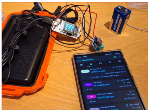
Meshtastic med Lora och batteri inbyggt. Även en app till telefonen
