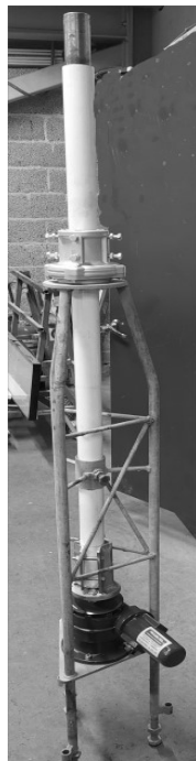
”Kronan” med undre rotor Prositel. Eleveringsrotor skall sitta i topp-röret!
