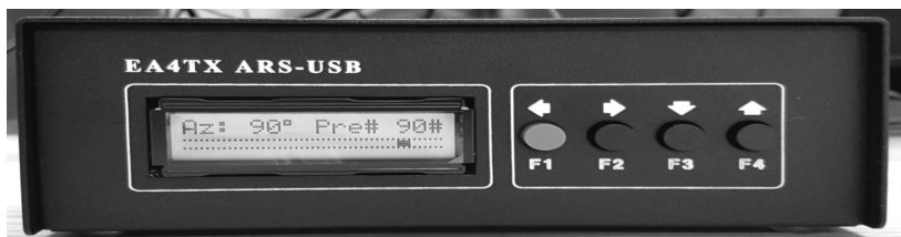
Styrboxen vid Op 1. Denna modell har också möjlighet att styra elevering av antenner om behovet skulle uppstå.
