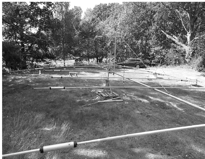
9 el Mosleybeam ska upp i masten
