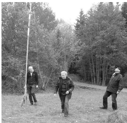
Antennuppsättning på Gålö. En 18AVQ anpassad för 40 m sattes upp på fotbollsplanen. Ingemar /DSF, Kalle/ NUE och Jan-Olof/IFP. Nackspärr är en yrkesskada i denna hobby.
