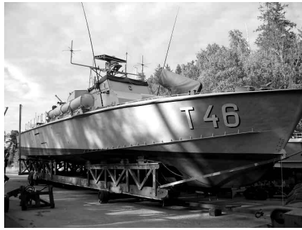
T46 från 1957. Mest imponerande på en landkrabba är det tre Isotta Fraschini-motorerna med 18 cylindrar vardera, 57 liter, 1500hp/motor. Bränsle: Flygbränsle. Dessa ger båten en maxhastighet av 45 knop!
